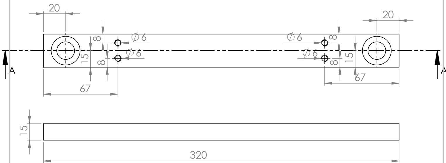
**Les perçages de diamètre 6 sont traversants et taraudés de pas gros ISO. M6 pas 1 mm.**
