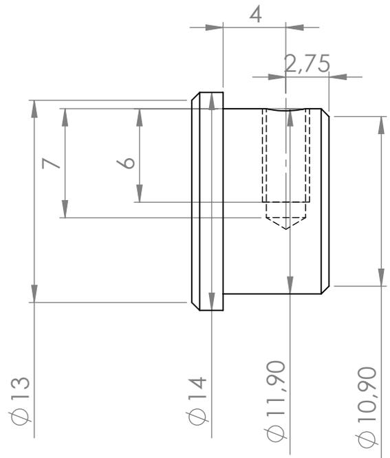
Profondeur utile taraudée = 6mm
