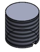
Le diamètre extérieur des vis doit être compris entre 13 et 15mm
