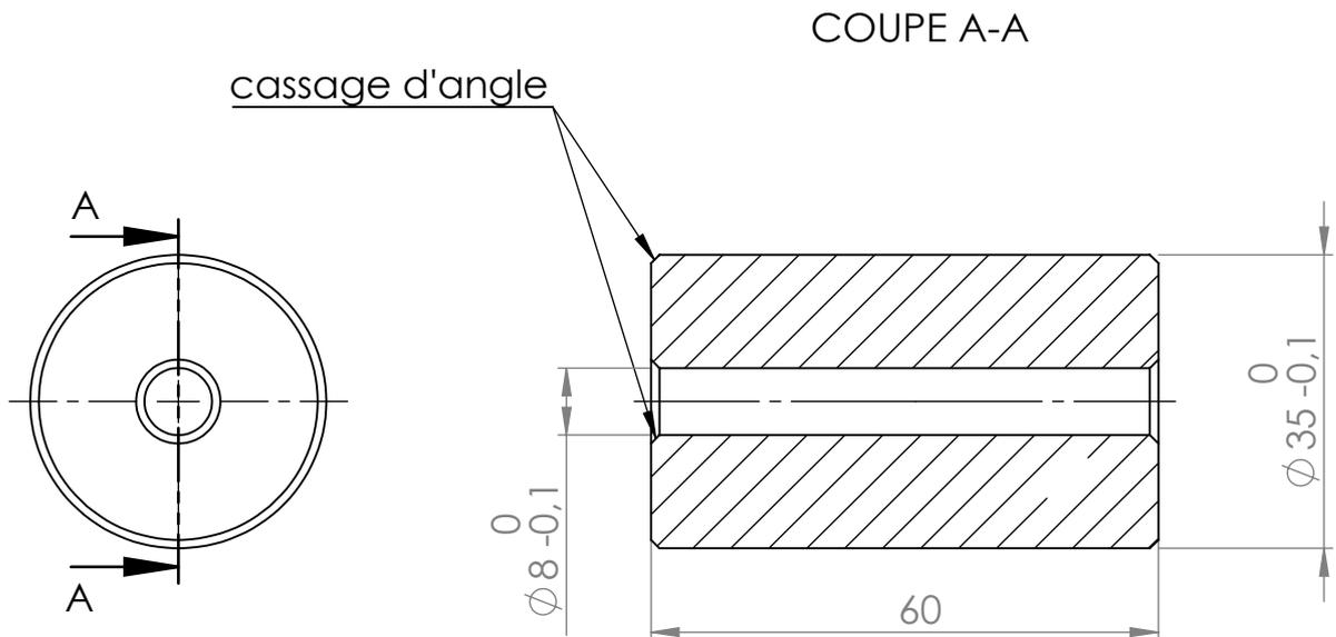
si le brut est une barre rectifiée type dia 35h7, la tolerance 0/-0.1 non utile
