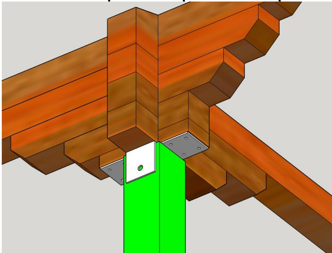
**Vue de dessous platine sur charpente**
