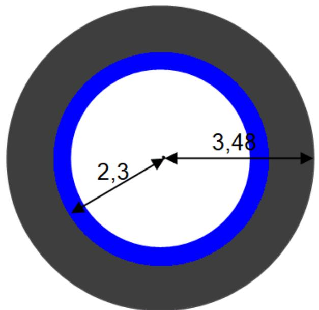
Sur les vues ci-dessus. En bleu : Taraudage M4. Les mesures sont données en millimètres.
