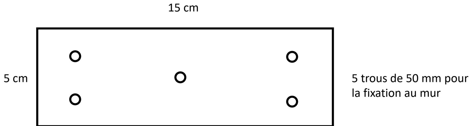
5 trous de 50 mm pour la fixation au mur
